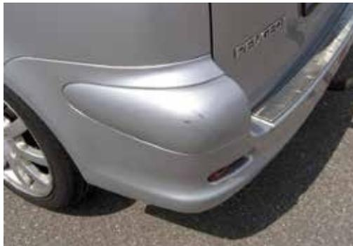
3. Beschädigungen am Lack, bei denen eine Reparatur nicht erforderlich ist: bis zu zwei Schäden je Stoßstange. Bis zu 30 mm.
