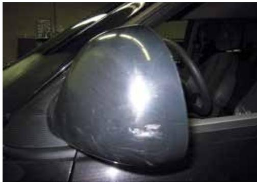
1. Nicht mehr als zwei Kratzer mit einer Länge von höchstens 50 mm, die (bei lackierten Spiegeln) die Lackschicht nicht durchdringen. Die Funktionsfähigkeit darf nicht beeinträchtigt sein.
