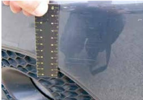
1. Scheuerstellen oder Kratzer mit einer Größe bis zu 10 × 5 cm, die (bei lackierten Stoßstangen) die Lackschicht nicht durchdringen.
