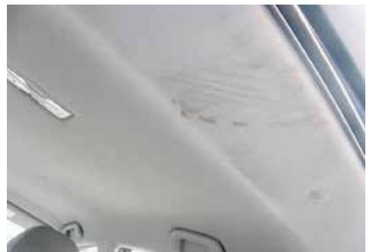
2. Die Innenverkleidung des Dachs ist verschmutzt. Es handelt sich nicht nur um oberflächlichen Schmutz; der Schmutz lässt sich nicht durch normale Reinigung entfernen. Die strukturierte Verkleidung des Dachs weist Risse im Material auf.
