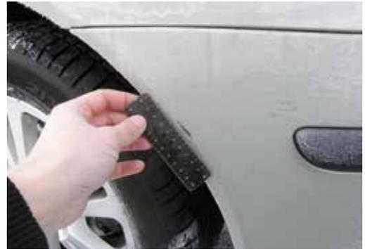
2. Bei einer lackierten Stoßstange dürfen die Kratzer (mit einer Länge bis zu 30 mm) nicht bis zum Trägermaterial durchdringen, und Dellen oder Beulen dürfen nicht größer sein als 30 mm.
