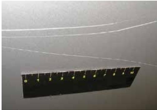
1. Kratzer mit mehr als 30 mm Länge oder mehrere Kratzer, die sich nicht durch Polieren entfernen lassen und dementsprechend eine Reparatur des Lacks notwendig machen.
