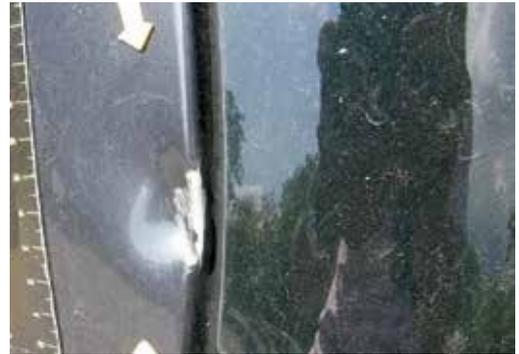
2. Dellen oder Beulen, bei denen die Lackschicht bis zum Trägermaterial beschädigt ist.
